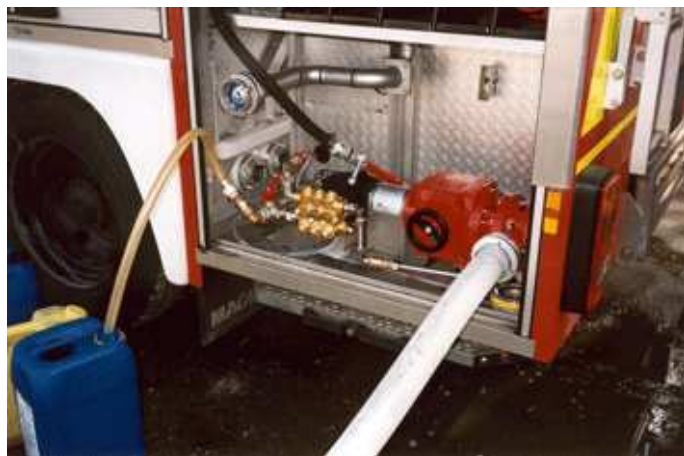
Figura 11.43. Generador de espuma de aire comprimido (CAF) incorporado en un camión.
