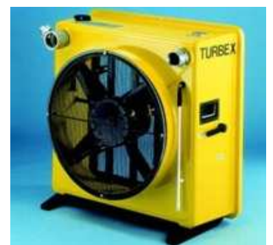
Figura 11.42. Generador de alta expansión de accionamiento hidráulico. El agua procedente del camión se aprovecha para generar espuma y para mover la turbina del ventilador, retornando parcialmente al camión.
