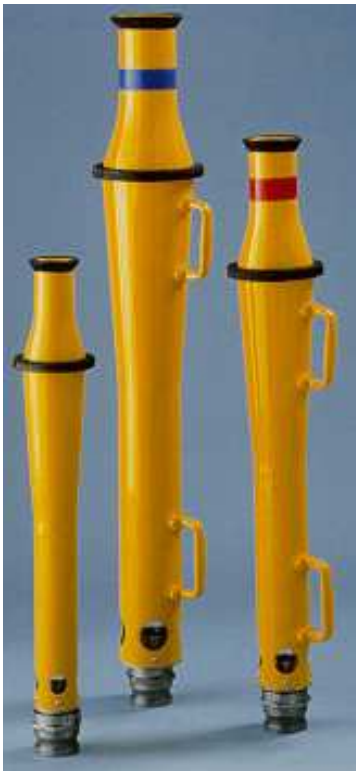
Figura 11.39. Lanzas de baja expansión. En la parte inferior se aprecian los orificios destinados a la aspiración de aire para producir espuma.
