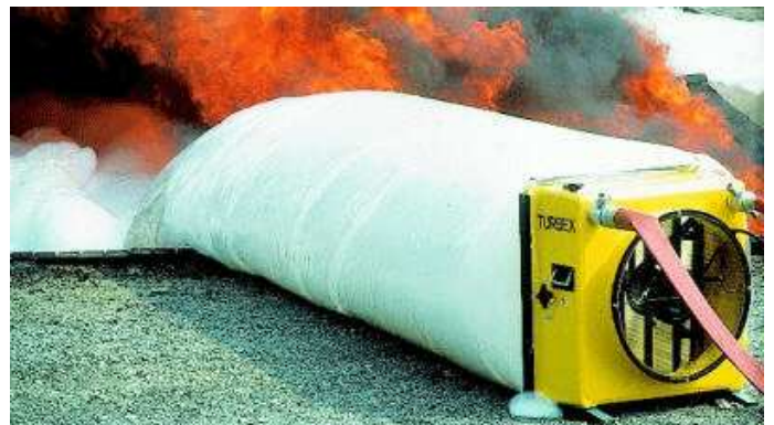
Figura 11.42. Generador de alta expansión de accionamiento hidráulico. El agua procedente del camión se aprovecha para generar espuma y para mover la turbina del ventilador, retornando parcialmente al camión.
