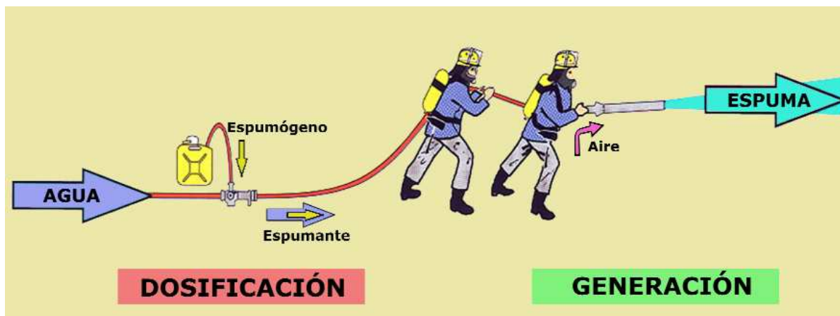
Figura 11.30. Las dos etapas de producción de espuma: dosificación del espumógeno en el agua para formar la solución espumante, y generación de la espuma mezclando el espumante con aire.
