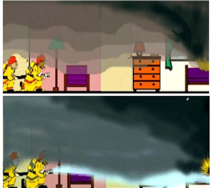
Figura 6.53. La aplicación de agua puede perturbar la estratificación térmica, y dificultar las tareas de extinción.
