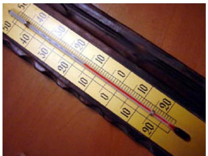
Figura 6.10. Los termómetros se basan en la dilatación de un líquido dentro de una escala graduada.
