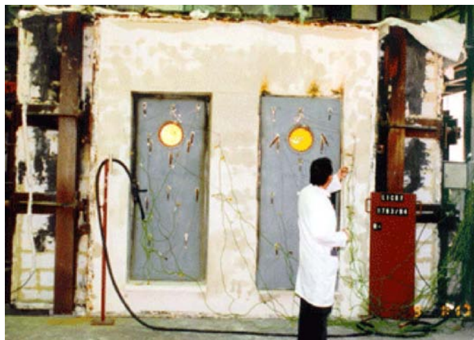
Figura 32.6. Ensayo en un laboratorio de puertas resistentes al fuego, montadas sobre la pared del horno de ensayo.
