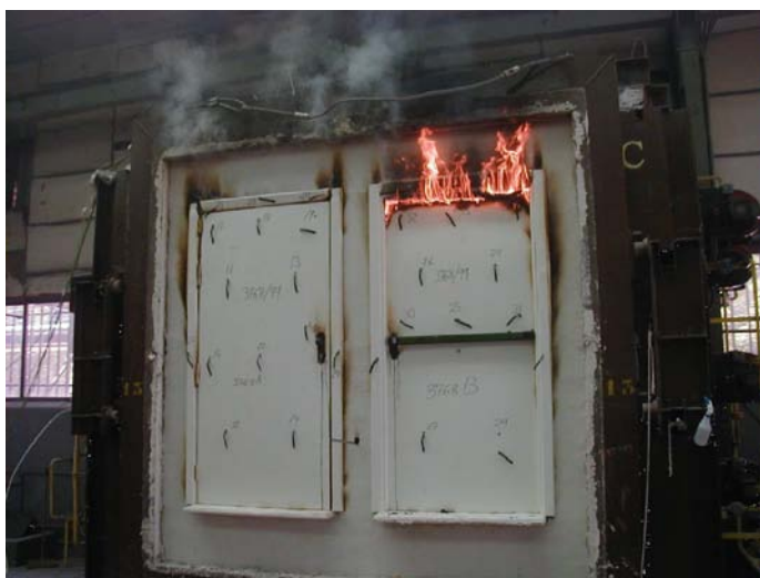
Figura 32.8. Ensayo de puerta resistente al fuego, en el momento en que se inflaman los gases en el exterior del horno.
