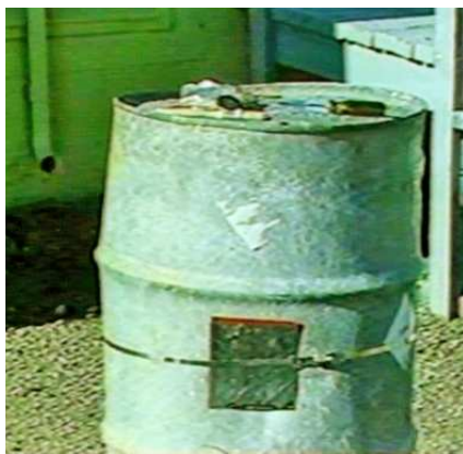
Figura 25.37. Bidón parchado con una lámina de neopreno, presionada contra el bidón por una chapa metálica y un cincho.
