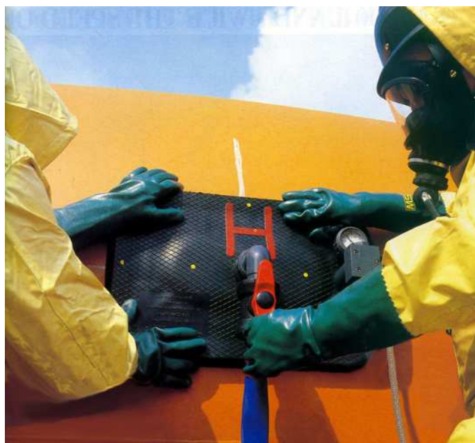
Figura 25.39. Cojín accionado por aire comprimido, capaz de adherirse al recipiente, que permite recuperar el producto.
