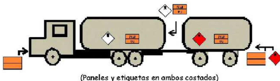
Figura 25.20. Situación de etiquetas y paneles naranja en una cisterna con remolque.
