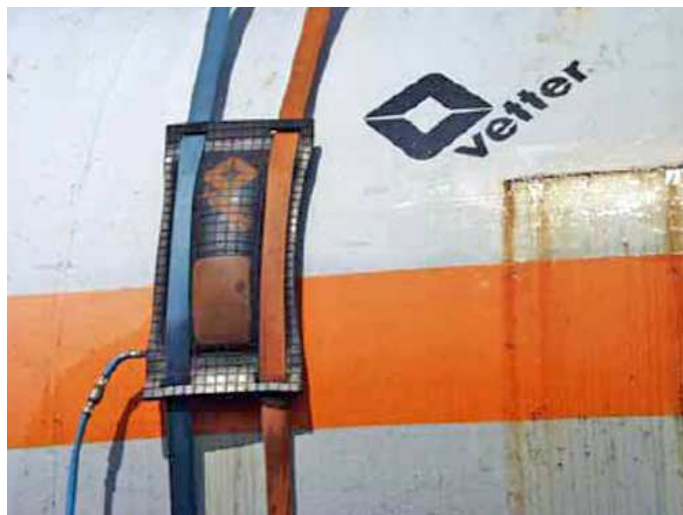
Figura 35.38. Parcheo con un cojín hinchable sujeto por cinchas a una cisterna.
