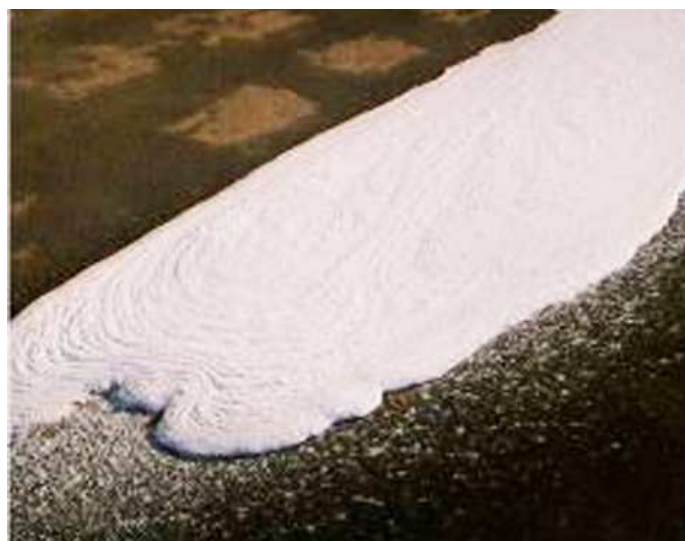
Figura 7.18. Imagen de una espuma de aire comprimido (CAF), en la que se aprecia su densidad.
