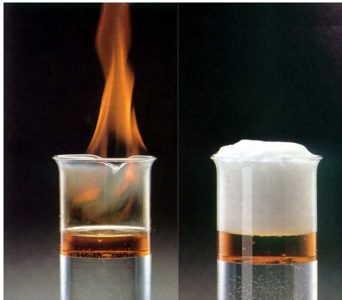
Figura 7.10. La espuma flota sobre los líquidos combustibles y sofoca el fuego separándolos del oxígeno del aire.
