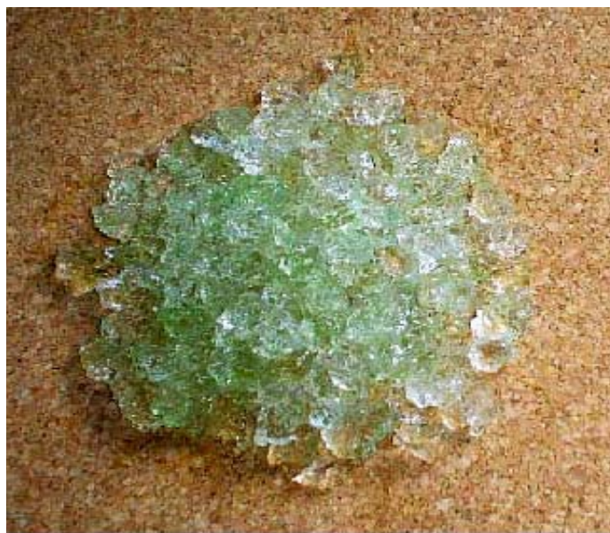
Figura 7.9. El agua con aditivos espesantes se transforma en un gel.
